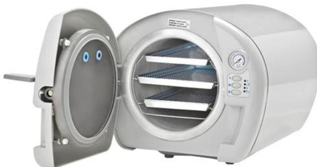
1. Selecionar o ciclo de esterilização de acordo com a carga de material a ser esterilizado e o manual do fabricante, podendo utilizar ciclos a 121°C, 127°C ou 134°C.
