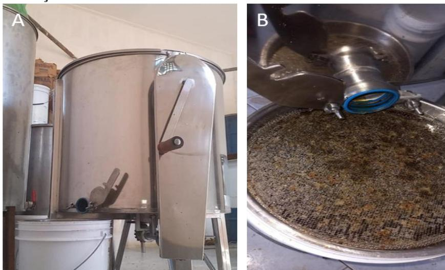
**Fonte:** Arquivo pessoal. **Legenda:** A - Centrífuga utilizada para a extração do mel; B - Filtração utilizando a peneira para retirar partículas sólidas do mel, por exemplo, algumas partículas de cera.
